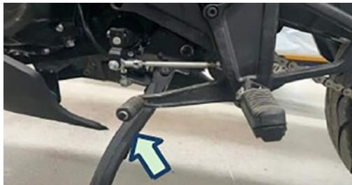
Este vehículo está equipado con un soporte lateral (o pata lateral) en el lado izquierdo del vehículo. Cuando utilice un soporte lateral para apoyar la motocicleta, coloque el pie en el extremo del soporte lateral, presione firmemente el soporte para que gire hasta el final y se apoye en el suelo.
