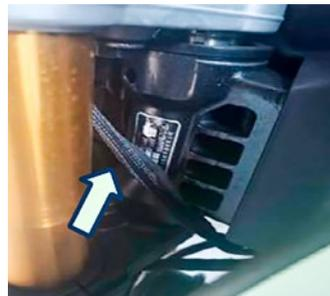
El número de bastidor (o número VIN) está grabado en relieve en la pipa de la dirección en el chasis. Mientras que el número de motor está grabado en el lado izquierdo del motor. La placa de identificación metálica está instalada en el bastidor y se utiliza para indicar los principales parámetros técnicos de este modelo.
