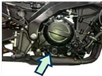
**Cambio de aceite y filtro:** El aceite del motor y el filtro de aceite deben cambiarse en los primeros 500 kilómetros y posteriormente cada 5.000 kilómetros. El aceite debe cambiarse cuando el motor esté caliente para que pueda drenarse completamente. El método es el siguiente:
