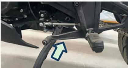
**⚠ PRECAUCIÓN:** Cuando la transmisión está en punto muerto se enciende el testigo N del cuadro de instrumentos, a pesar de que el testigo esté iluminado, la maneta del embrague debe ser cuidadosa liberada para determinar si la transmisión está realmente en la posición neutral.
