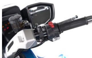
**Freno delantero:** La distancia entre el estado de reposo del freno y el momento en que se acciona el freno se denomina "recorrido libre". En los modelos con frenos delanteros de disco, la holgura de la palanca de freno debe estar entre 5 y 10 mm.
