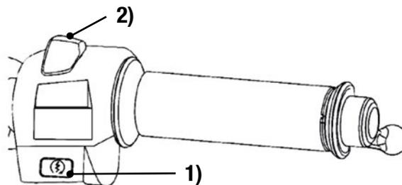
1) **Pulsador de arranque** “
