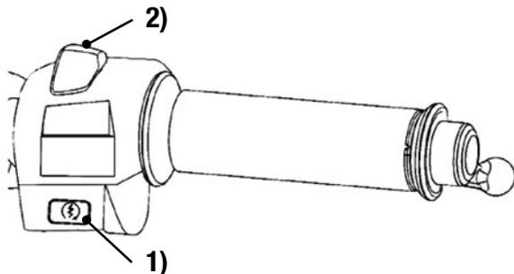
Una ilustración técnica en blanco y negro que muestra una palanca de freno y un botón de arranque. La palanca de freno está etiquetada con el número '2)' y el botón de arranque con el número '1)'. El botón de arranque tiene un símbolo de un círculo con una línea diagonal.
